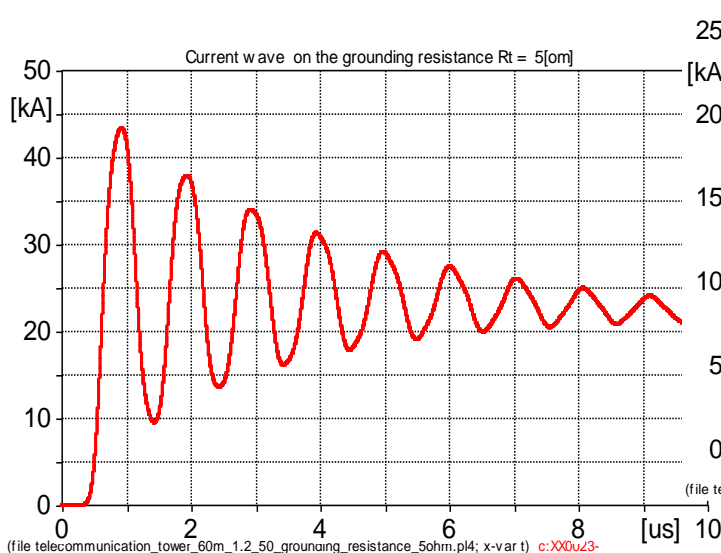
Fig. 9 Vala e rrymës me rezistencë tokëzimi R_t = 5 [\Omega] për valën standarte 1.2/50 [ \mu s ] të burimit të rrymës së rrufesë, me rrymë pikë 100 [kA] në krye të kullës
